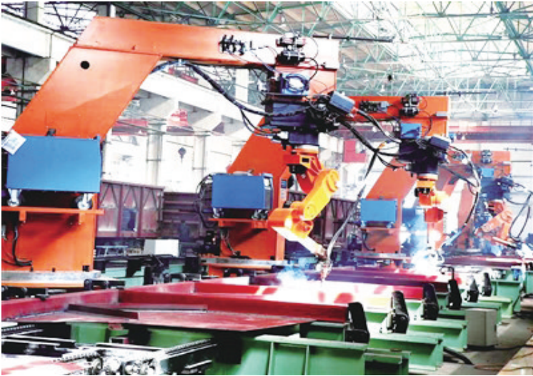
内蒙古一机集团铁路车辆侧墙自动焊接生产线。 (图片由青山区党委宣传部提供)
