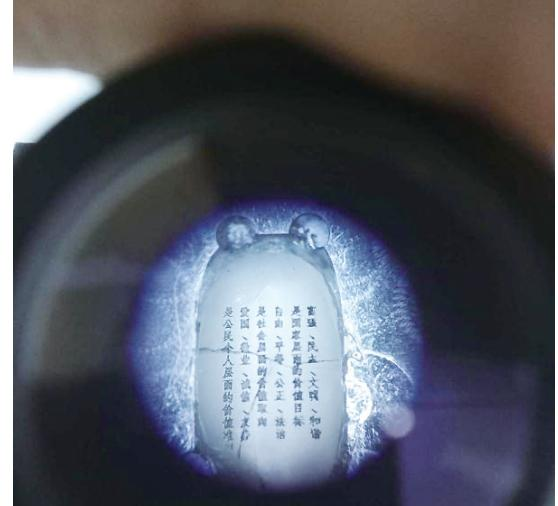
新华社消息 在一粒米上铣出56个汉字,在一根头发丝上铣出7个字母……记者从中国五矿集团有限公司了解到,中国五矿所属中钨高新金洲公司近日成功研制直径0.01毫米(大约相当于人类普通头发丝直径的八分之一)的极小径铣刀,并实现了上机加工。
