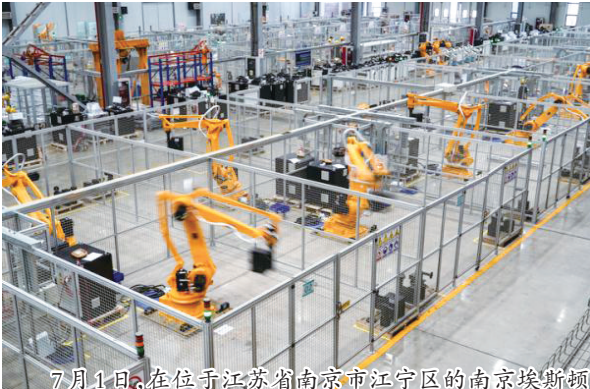
7月1日,在位于江苏省南京市江宁区的南京埃斯顿自动化股份有限公司工业机器人生产车间,工业机器人在进行跑合测试。摄影/新华社记者 李 博
