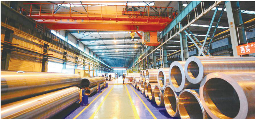
北重集团超超临界机组高品质大口径厚壁无缝钢管
