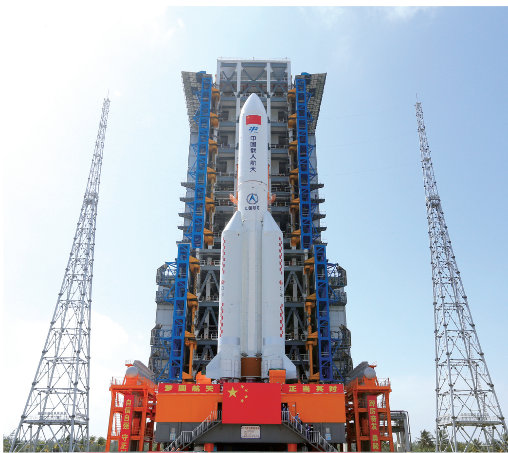
10月25日,梦天实验舱与长征五号B遥四运载火箭组合体转运至发射塔架。
