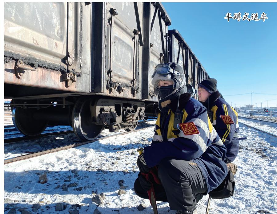
车开行过程中会产生不同的作用力,长途运输容易造成车辆配件磨损,需要检车员依靠丰富的技术经验做出判断,找到隐患。
