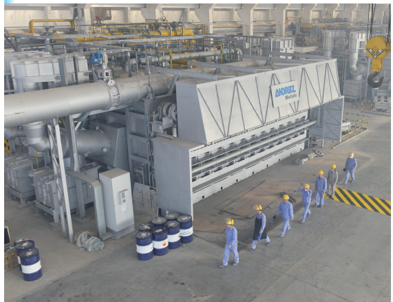
霍林郭勒市联晟新能源材料股份有限公司引进的哈兹列特连铸连轧法工艺生产线是世界上最先进的铝板带箔加工工艺之一,今年投产后将实现年产值300亿元,拉动就业5000人。
