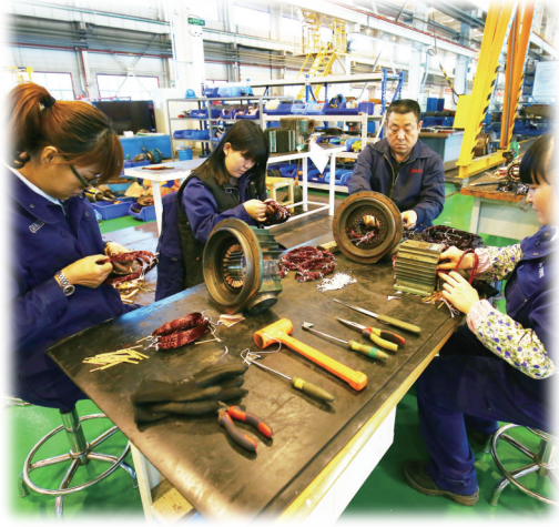
鄂尔多斯市伊金霍洛旗神华神东煤炭集团维修二厂的技术人员正在进行电动机嵌线维修作业。截至目前,该厂创收突破4000万元。深化供给侧改革,依托自身技术优势,将维修业务范围从集团内部向行业其他企业延伸,员工们意气奋发。
