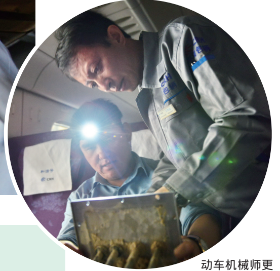
动车机械师更换电炉加热管。
