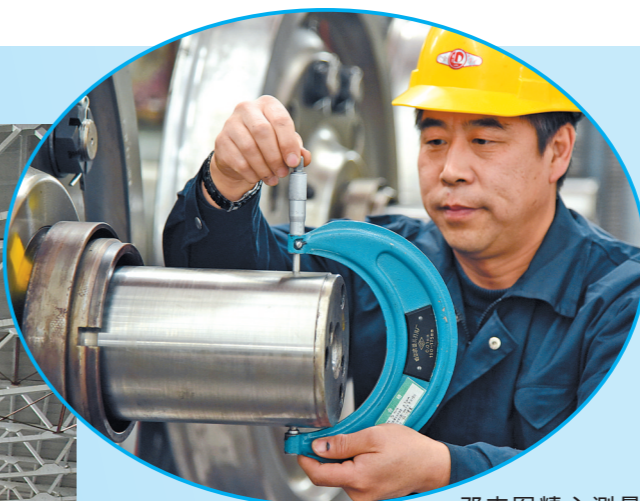
邓志军精心测量轮对轴头尺寸。
