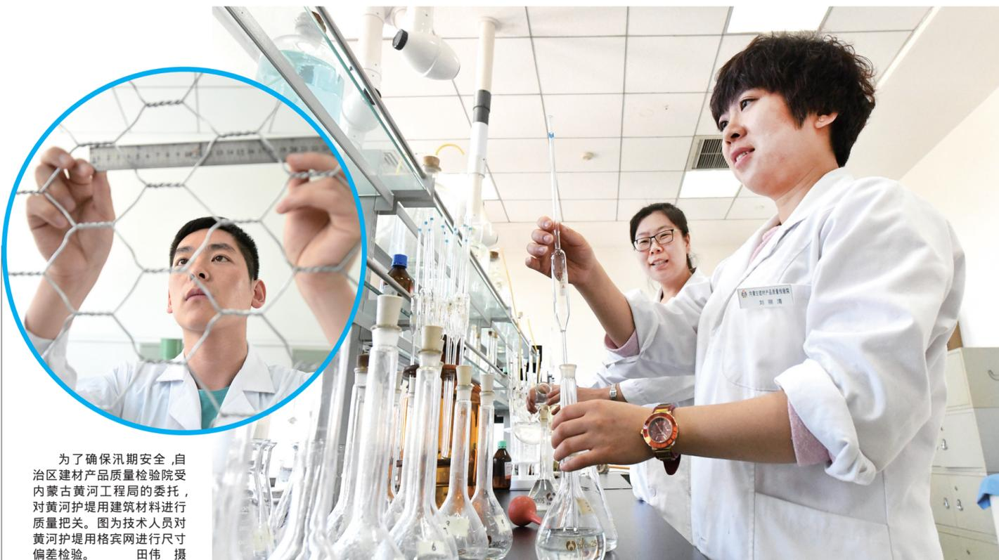
为了确保汛期安全,自治区建材产品质量检验院受内蒙古黄河工程局的委托,对黄河护堤用建筑材料进行质量把关。图为技术人员对黄河护堤用格宾网进行尺寸偏差检验。 田伟 摄
