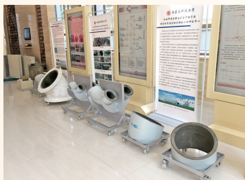
这些大大小小、形状各异的管子、弯头的内壁都是微晶玻璃材质。
