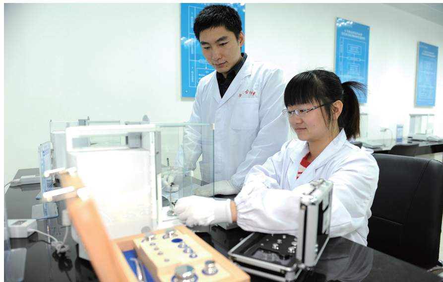
检定自治区各盟市计量技术机构溯源的“标准砝码”,保障全区量值准确可靠。
