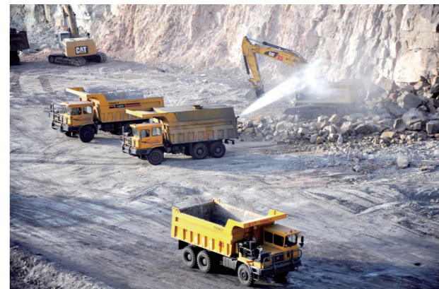
露天开采使用洒水抑尘作业。海东 摄
