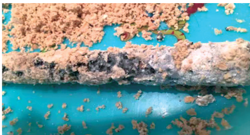
由于热水器的长期工作,镁棒在使用一段时间后就产生许多水垢。
