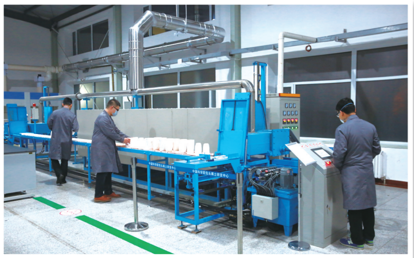
世界首条稀土硫化物着色剂连续化隧道窑生产线。
