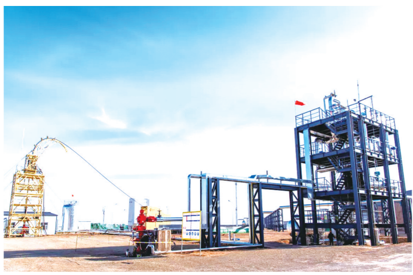
中科院包头稀土研发中心在包头市开展绿色环保稀土着色剂中试工艺研发,建成了世界首条稀土硫化物着色剂连续化隧道窑生产线。
