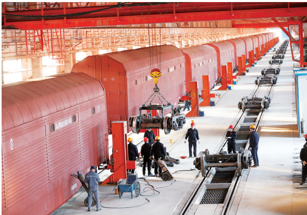
作业人员正在将我国使用的标准转向架从车底吊出。 本报记者 梁亮 摄
