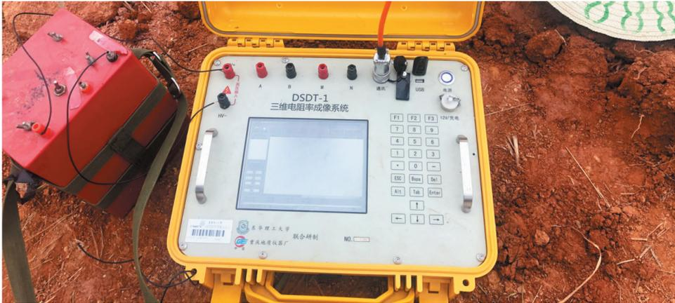
这是三位电阻率成像系统(2020年7月16日摄)。该设备可以应用于探测堤坝险情,透视坝体结构,快速判断堤坝是否存在空洞、裂缝、管涌等隐患。新华社发
