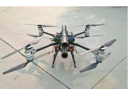
高楼火灾现场，一架造型科幻的多旋翼无人机破空而至，在火灾楼层窗外悬停、瞄准、发射，灭火弹击碎窗户，灭火剂在火场弥漫开来。
