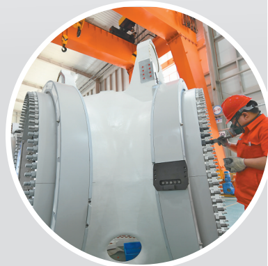
为风机主机涂抹防腐剂。
