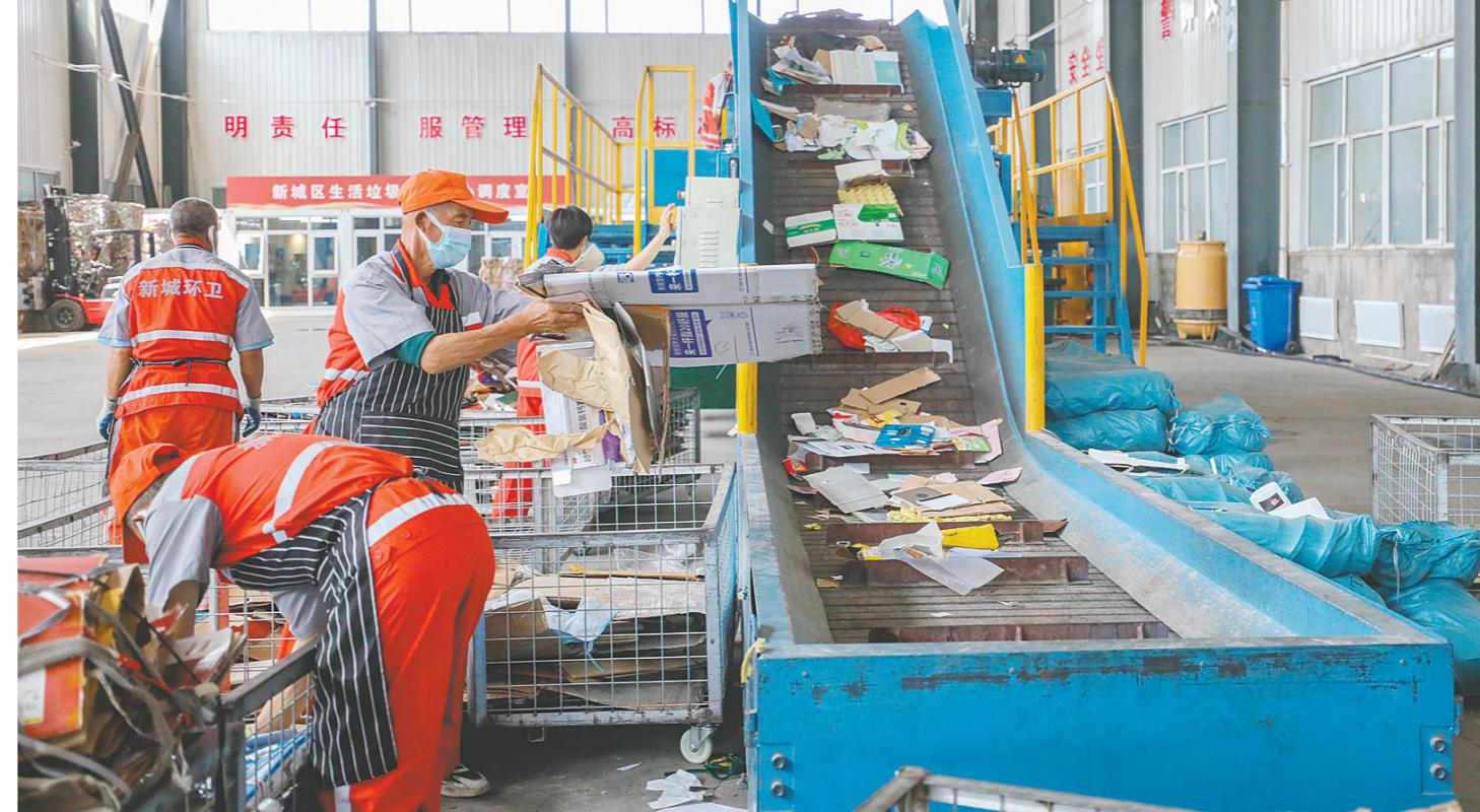
8月16日,呼和浩特市新城区生活垃圾分拣中心,工人们正在分拣打包垃圾纸片。据了解,该中心集可回收垃圾精细分拣打包、大件垃圾拆卸分解、厨余垃圾发酵堆肥、有害垃圾分类暂存等功能于一体,可日处理垃圾300吨,实现了生活垃圾由粗放式管理到精细化管理的升级,达到了减量化、资源化、无害化的目的。
