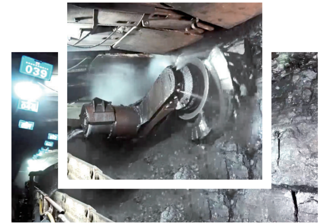
▲窝兔沟煤矿综采工作面记忆割煤。
