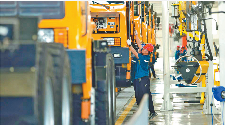
内蒙古铁辰智能装备有限公司总装车间内技术人员正在生产百吨级宽体矿用卡车。该车间采用最新信息化、自动化技术,实现了产品质量与生产效率的双重提升。 杨晓磊 摄
