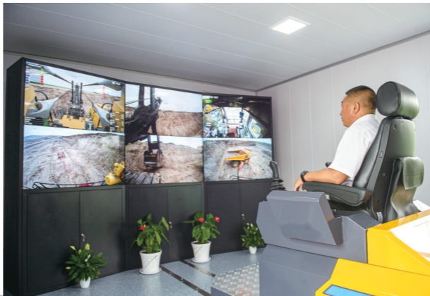
南露天煤矿员工在全仿真驾驶舱内对距其7公里外的电铲挖掘机进行遥控作业。
