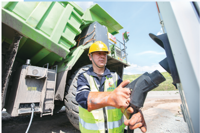
南露天煤矿自卸车司机正在进行百吨级纯电动交流传动矿用自卸车充电作业。
