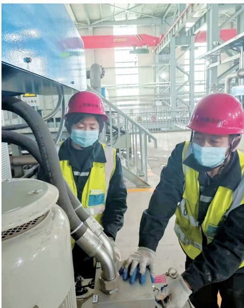
内蒙古包盈环保新材料有限公司工作人员正在点检板框压滤机液压系统。
