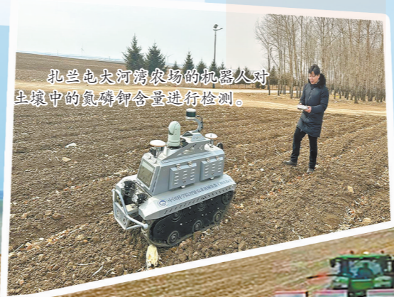
扎兰屯大河湾农场的机器人对土壤中的氮磷钾含量进行检测。
