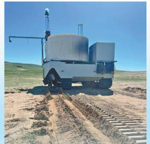
全天候无人种植机器人实现开沟、植苗、浇水、覆土全流程作业,有效提升治沙效率。王佳敏 摄
