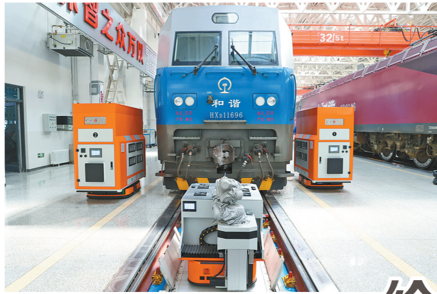
智能吹扫除尘机器人正在作业。
