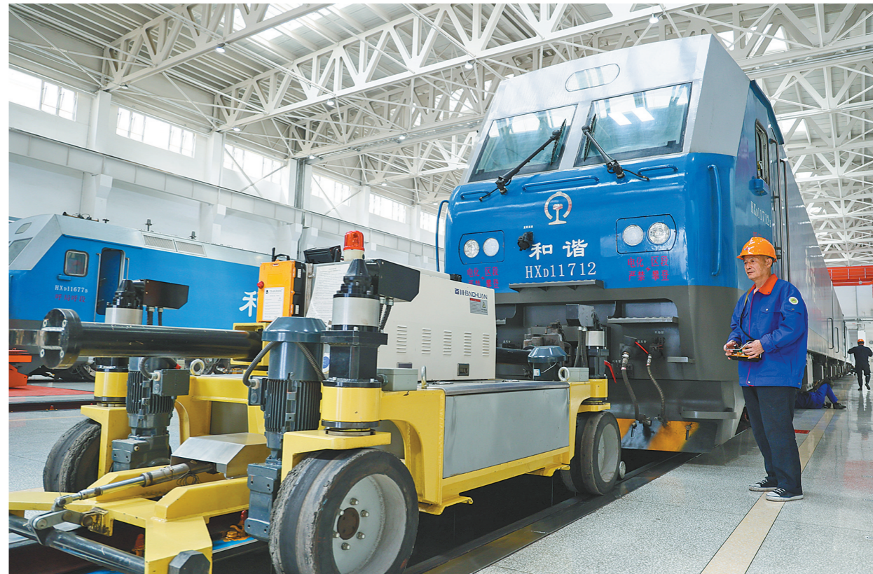
操作铁轨两用牵引车。
