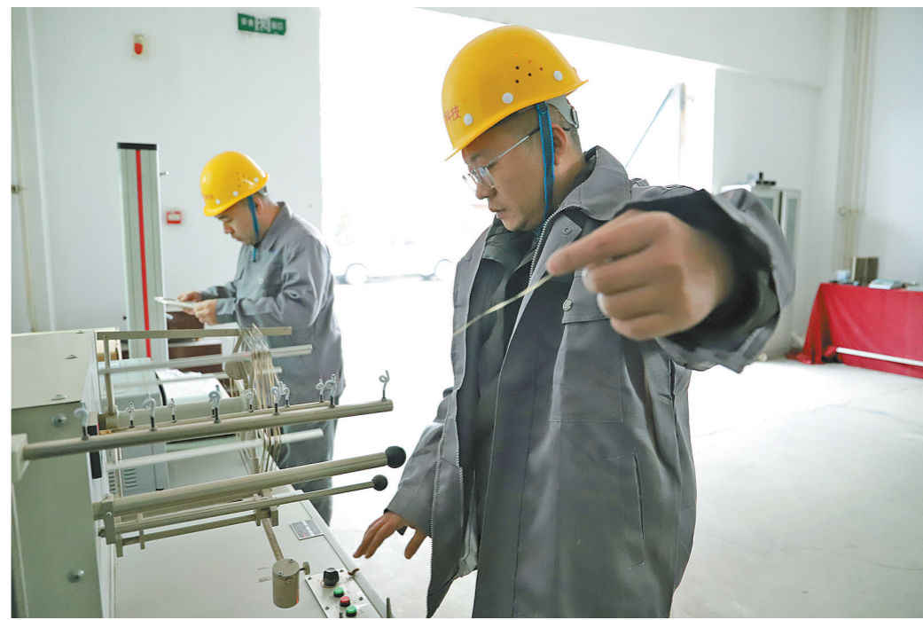
内蒙古科学技术研究院技术人员正在测试玄武岩纤维的丝径。
