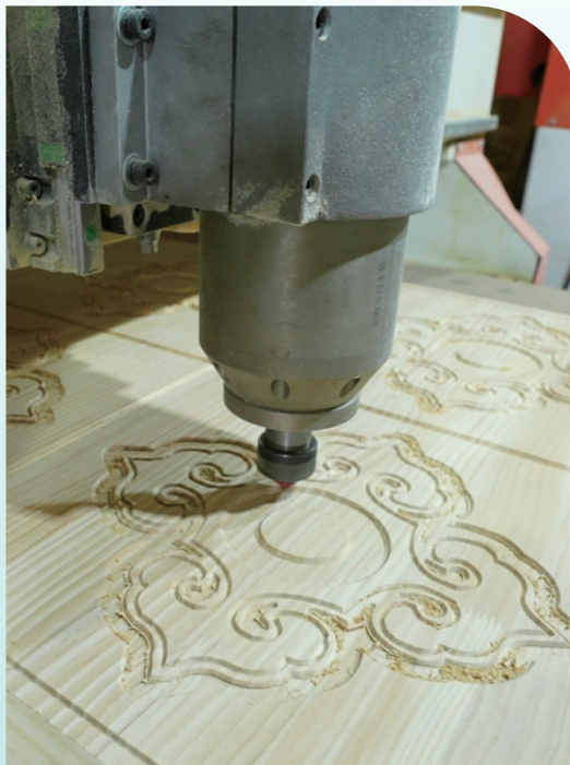
电子雕刻机正在雕刻蒙古包上的花纹图案。
