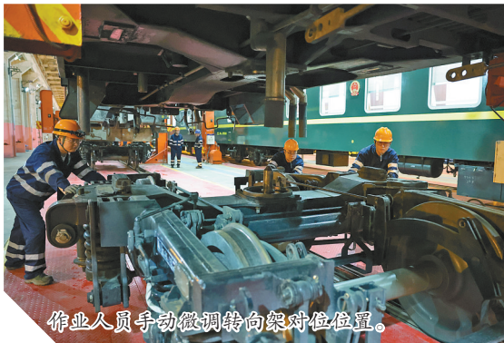
作业人员调整转向架侧承间隙。
