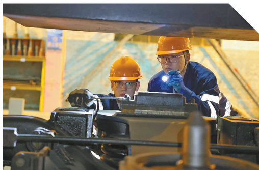
作业人员调整转向架侧承间隙。
