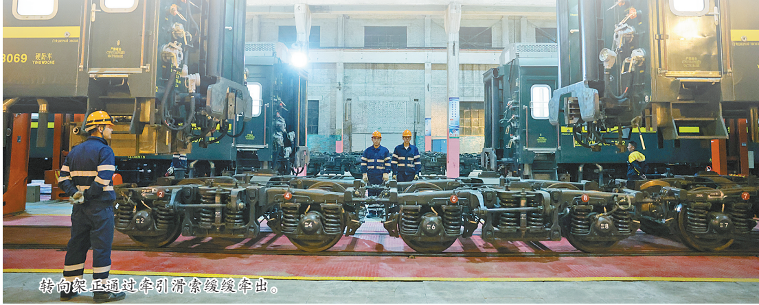
作业人员手动微调转向架对位位置。
