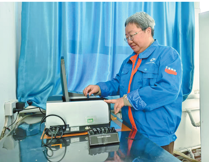
内蒙古北方重工业集团有限公司科研人员使用分光光度计,检测材料吸光度。
