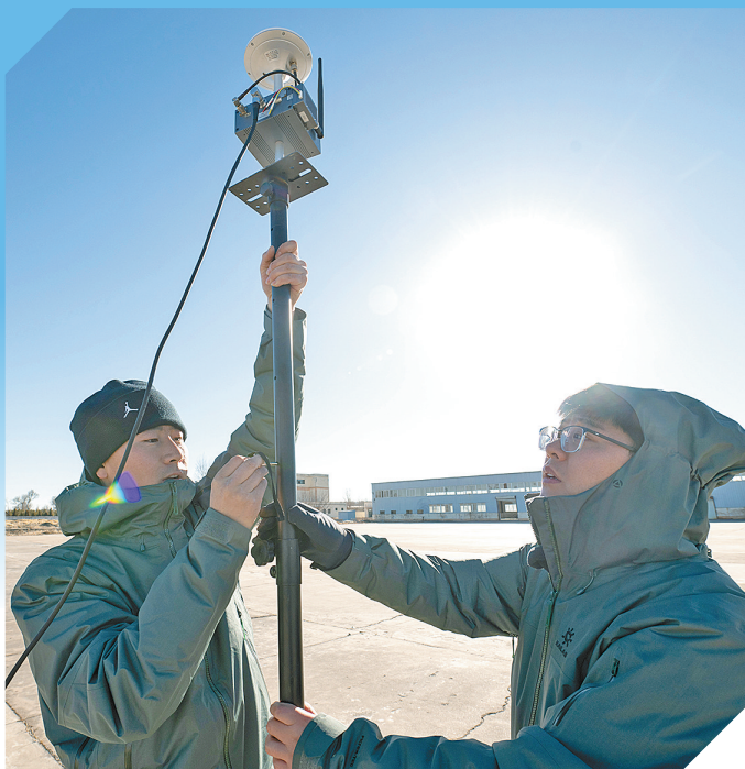
搭建架设无人机探测系统地面监测设备。
