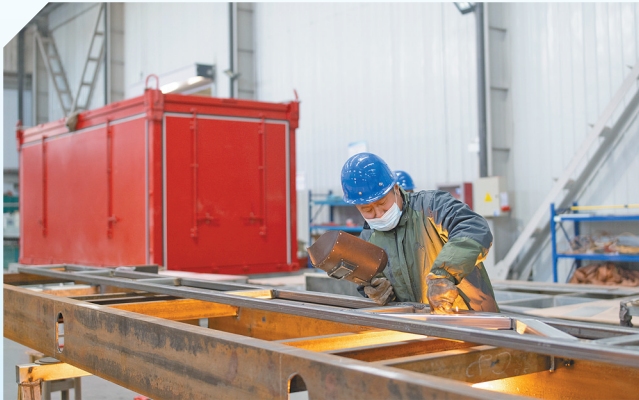
工人焊接太空舱钢架。
