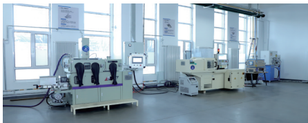
注射成形技术制备复杂结构烧结稀土基金合金装备。
