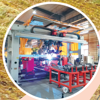
中农机华德车间焊接机器人生产现场。
