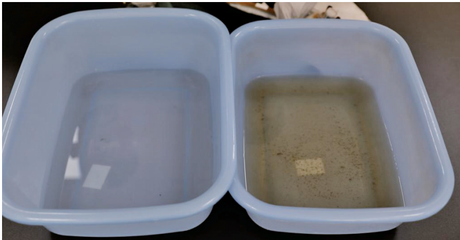
图左为合格暖手宝里的干净液体,图右为不合格暖手宝里浑浊的液体
