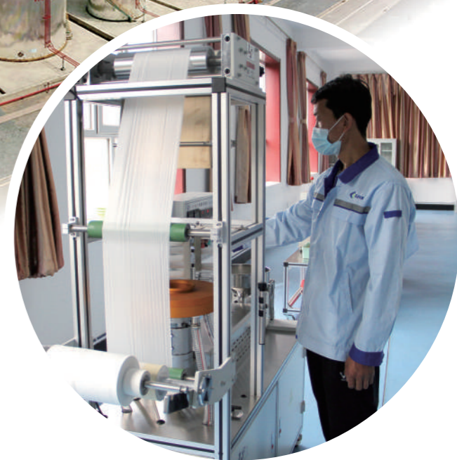
工作人员操作吹膜试验机生产PBAT塑料薄膜。黄建飞 摄
