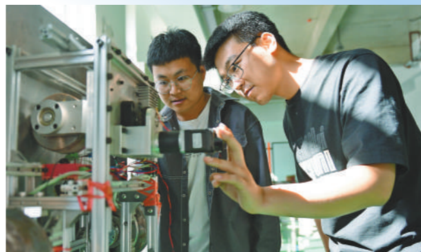
团队成员进行风机塔筒涂层自动化检测与清洗机器人姿态控制方法验证。
