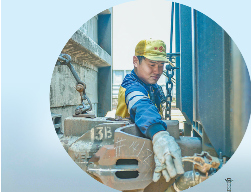
调车员打开折角塞门。 动车辆制动软管通风。
