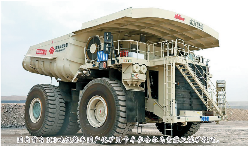
国内首台300吨级整车国产化矿用卡车在哈尔乌素露天煤矿投运。
