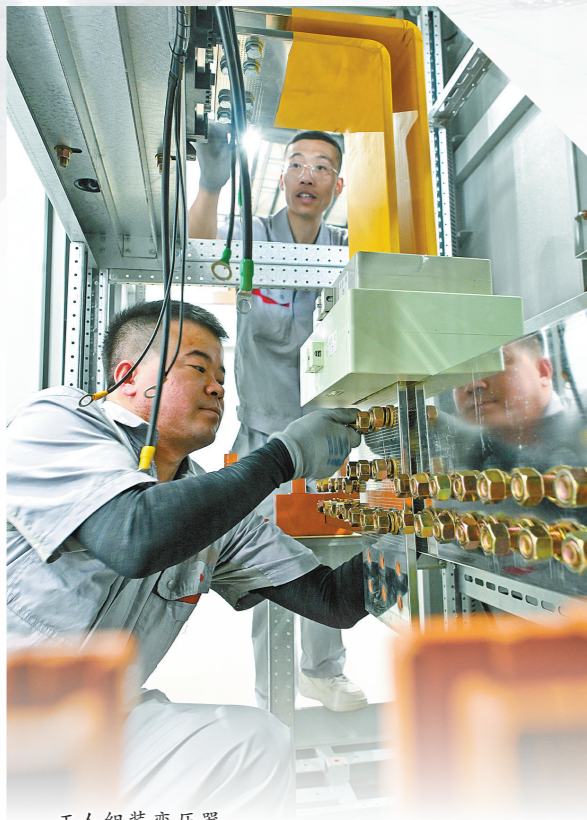
工人组装变压器。
