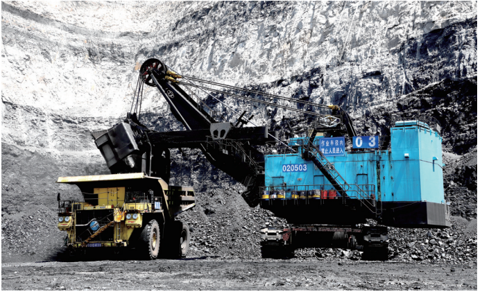
黑岱沟露天煤矿电铲装车作业。
