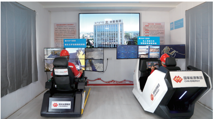
液压正铲、无人驾驶矿用卡车远程操控作业。
