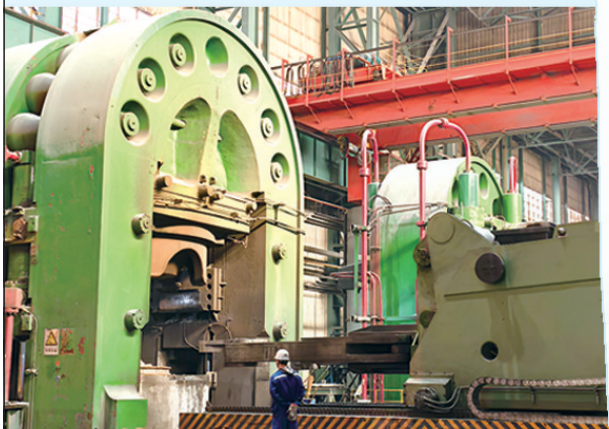
北重集团3.6万吨黑色金属垂直挤压机。
